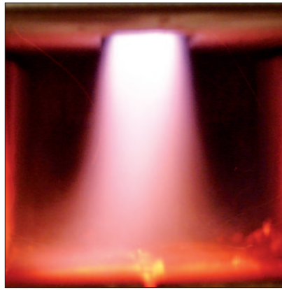
La completa combustione dei gas avviene nella camera di combustione inferiore
